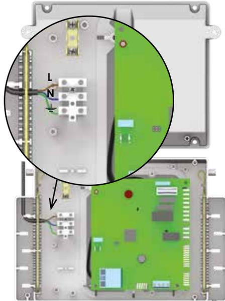
**Per le connessioni o la sostituzione di conduttori utilizzare cavo di classe H05VV -F, H05VVH2-F CEI EN 60228) o superiori.**
